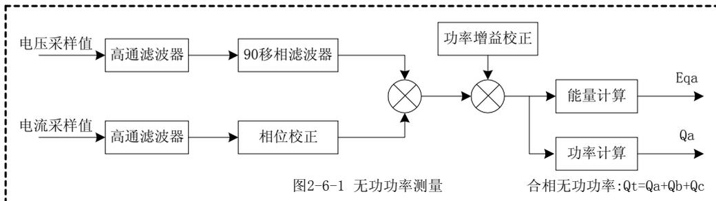
ATT7022A 采用的数字 90°移相滤波器具有优越的频率响应特性，如图所示。它是幅频特性为 1，频带范围内的所有频率成分进行-90°相移的线性滤波器。所以即使对于相当高次谐波无功功率的测量，也能获得很高的测量准确度。
