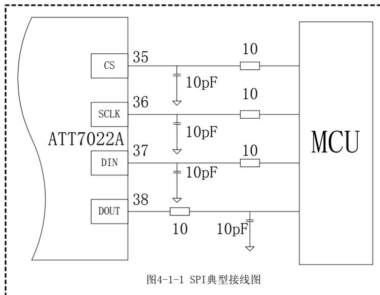
考虑 SPI 传输信号线有可能受到干扰或者出现抖动，可以在 SPI 信号线上串联一个小电阻。这个电阻与 IC 输入端的寄生电容 C 结合起来可构成一个低通滤波器，可以消除 SPI 接口信号上的任何振荡，一般推荐使用 10-100Ω 的电阻。如果数字输入端的内部电容不够大，还可在这个输入端加一个外接电容，可选 10pF 左右的电容。对于这两个电阻、电容参数选择，要根据 SPI 通讯速率以及外部 MCU 的型号进行分析，并需要作些相关的实验，以确定电阻、电容值是否合适。
