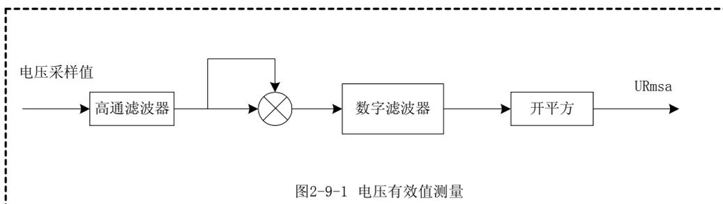
图2-9-1 电压有效值测量
