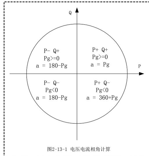
图2-13-1 电压电流相角计算
