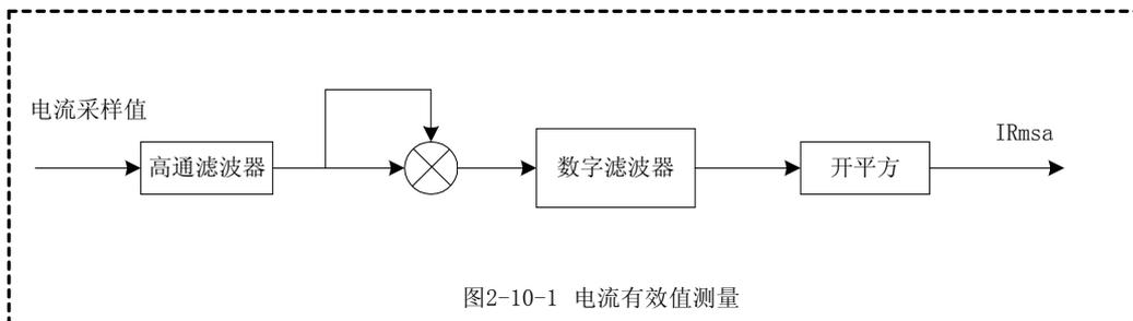
图2-10-1 电流有效值测量
