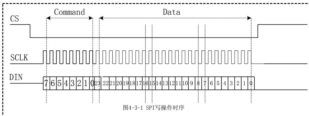
图4-3-1 SPI写操作时序
