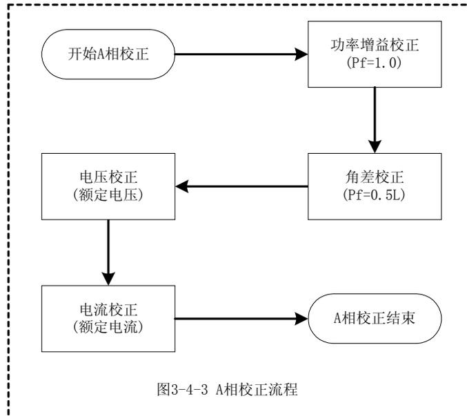
分相校正时，分相电流的校正可能会影响 A/B/C 三相电流矢量和寄存器 IRmst 的精度，所以对于电流有效值的校正请详细参考 3.3.7 电流校正寄存器部分的说明。
