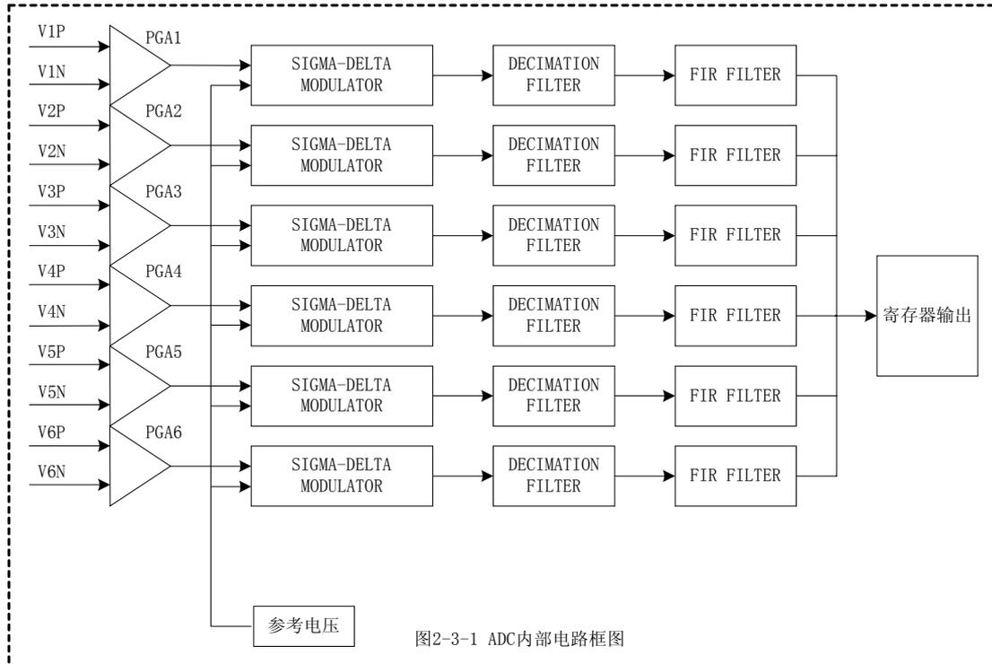
图2-3-1 ADC内部电路框图
